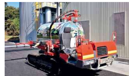
液肥散布車。キャタピラ付きで 田植え前の田んぼに進入して液肥を散布
