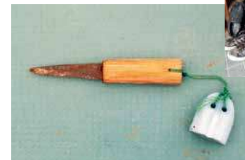
船で使用する小刀「マキリ」。海に落としても浮かぶように、プラスチックの浮きが付いている（平成9年4月6日）現在はマキリ自体にコルクの浮きが付着している（平成26年10月13日）
