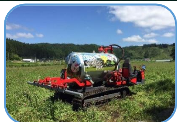
【生ゴミから抽出された液肥を畑(里)に散布する液肥散布車】 (合)MMR写真提供)
