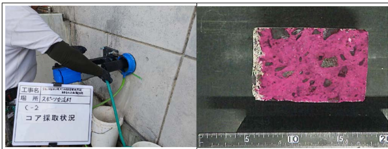
コンクリート中性化試験
