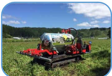
【生ゴミから抽出された液肥を畑(里)に散布する液肥散布車】 (合)MMR写真提供)
