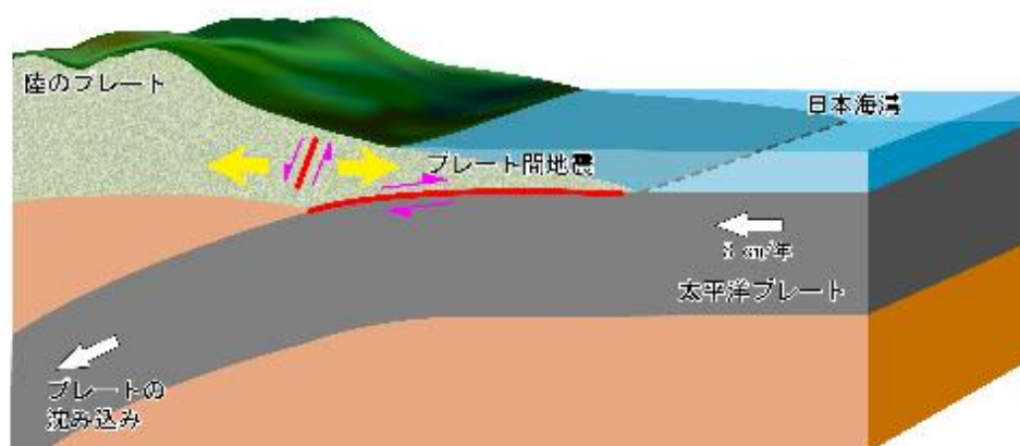
※ 4月11日 福島県南部のマグニチュード7.0の内陸地震。 ※ 赤線は断層面、ピンク色矢印はすべりの方向、黄色矢印は張力を表す。 2011年4月11日 福島県南部の内陸地震の発生メカニズム
