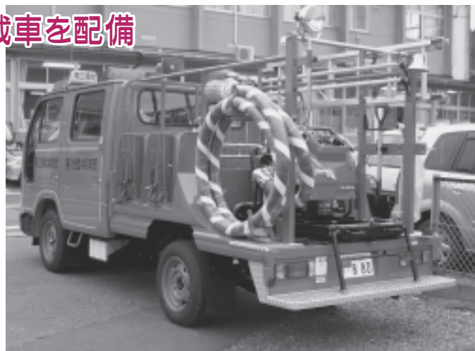
起動力に優れた小型動力ポンプを積載する車両
